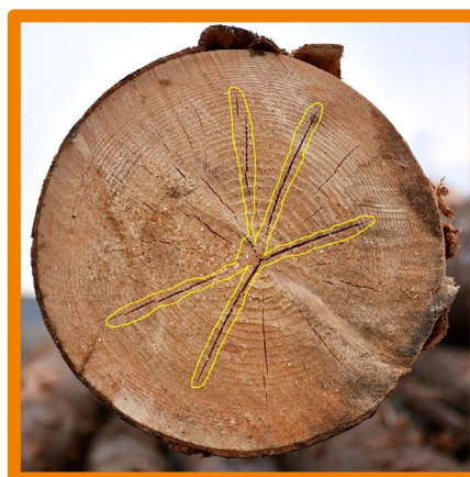
Crăpătură frontală superficială de inimă
