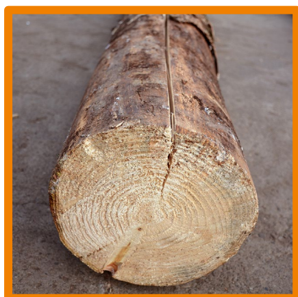
Crăpătură pe suprafața laterală
