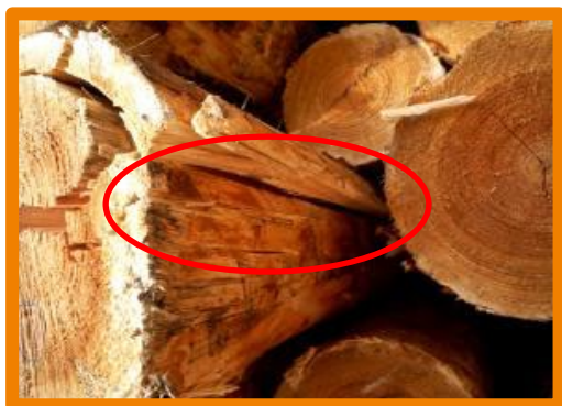
Crăpătură pe suprafața laterală
