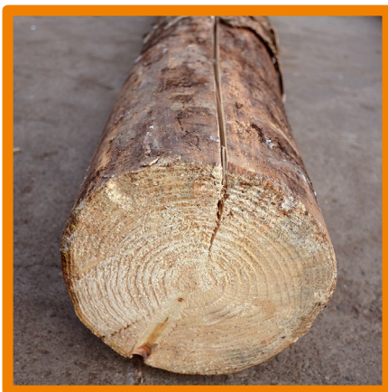
Risse entlang der Mantelfläche
