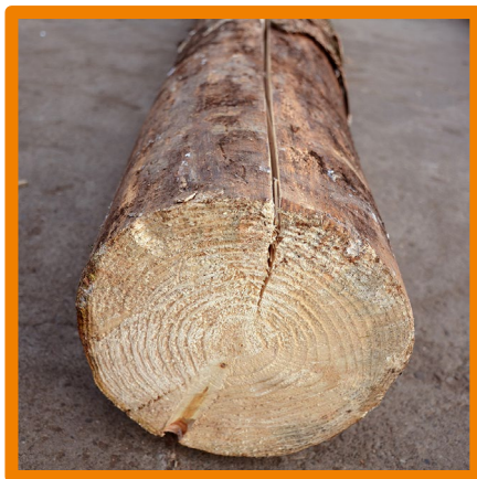
Risse entlang der Mantelfläche
